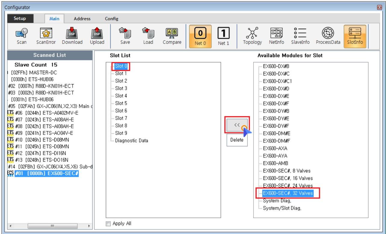
• 추가할 Slot과 Module을 각각 선택한 후, << 버튼을 클릭하면, Slot에 Module이 추가됩니다.
